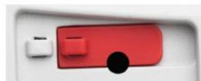
Блокировка включена и опломбирована бумажной пломбой
